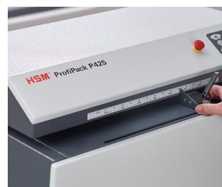
Dependiendo de la aplicación, el volumen del acolchado del material de embalaje se puede ajustar según sea necesario.
