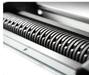
A través de un ajuste continuo de la anchura de trabajo mediante una escala, el material de acolchado puede fabricarse a medida con total exactitud.
